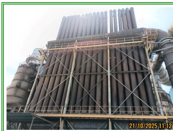
รูปที่ 3-2 อุปกรณ์ดักฝุ่นแบบถุงกรอง (Bag filter)
