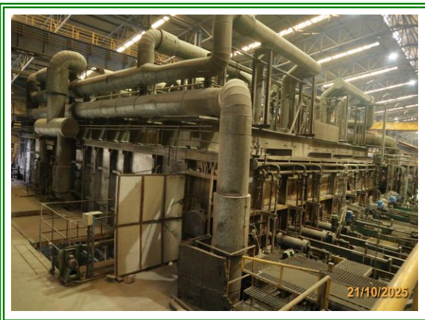
รูปที่ 3-13 ระบบควบคุมการเผาไหม้อัตโนมัติ โรงรีด 3
